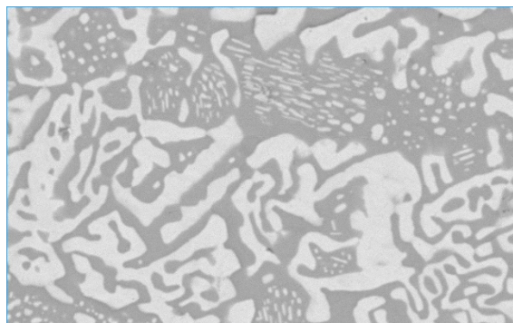
Obr. 28 2x přetavená Sn42Bi38 (3000x zvětšeno)
