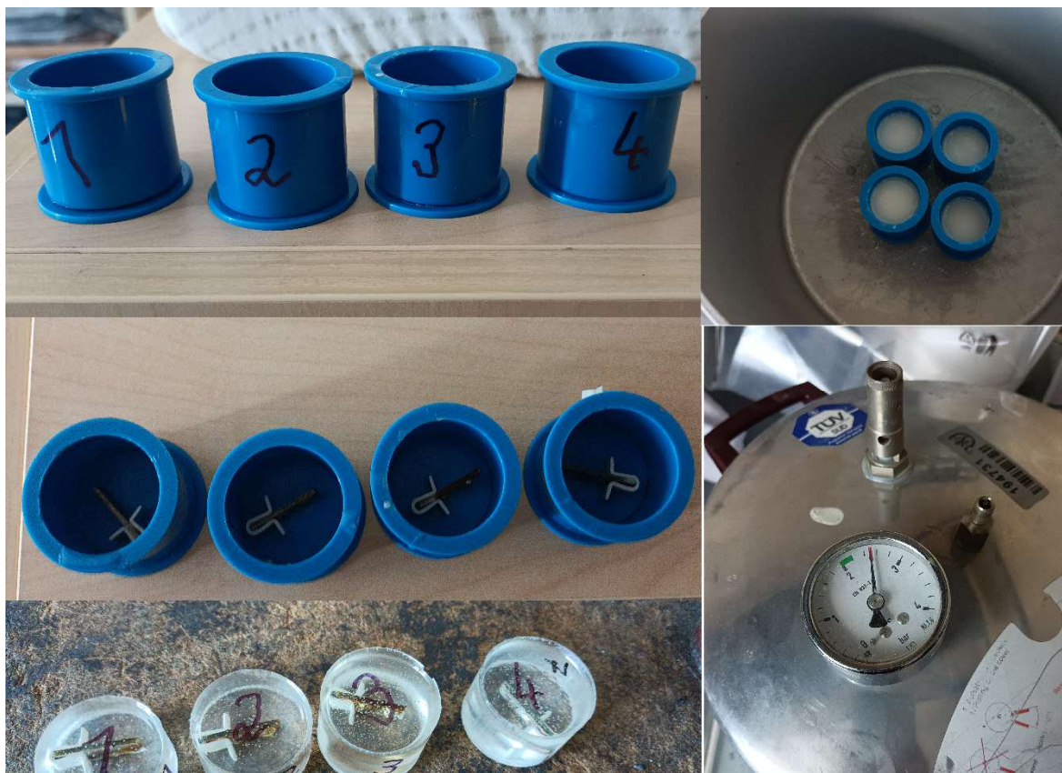
Obr. 8 Výroba materiálografických výbrusů
